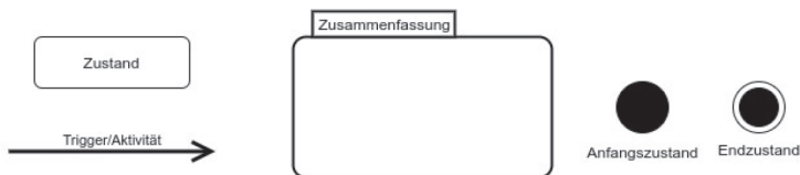
Abbildung 1: SysML Elemente für Zustandsdiagramme
